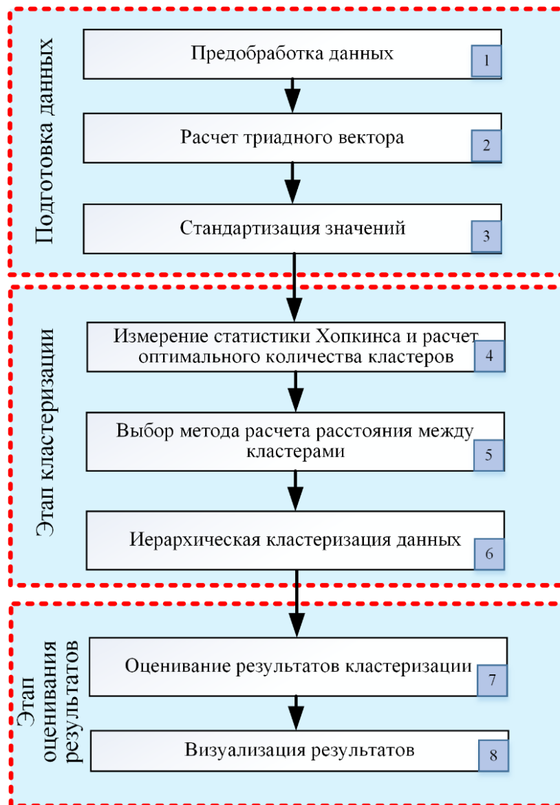
Рис. 2. Структурная схема метода распознавания топологий информационно-телекоммуникационных сетей на основе расчета триадного вектора
