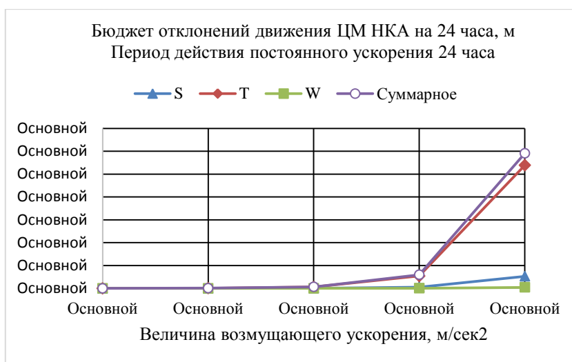
Рис. 3. Бюджет отклонения движения центра масс НКА по осям орбитальной системы координат (S, T, W)
