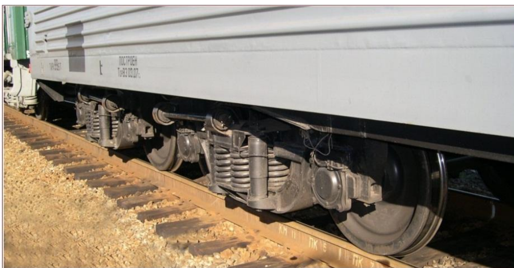
Рис. 14. Ходовая тележка с гидравлическими амортизаторами
